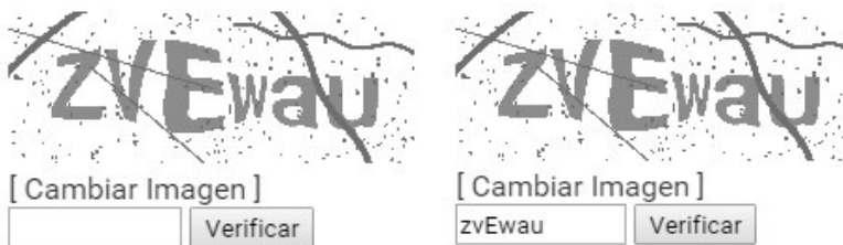
Ilustración 4. Método basado en OCR obtenido, muestra una imagen con caracteres alfanuméricos que deben ser ingresados en el campo textual para poder realizar la verificación del método, en este método es posible cambiar la imagen que se muestra.
