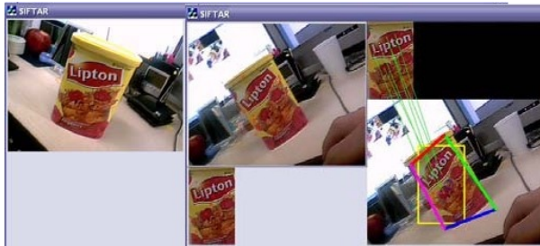
Fig 7. Detección de objetos usando el algoritmo SIFT, tomado de [12].
